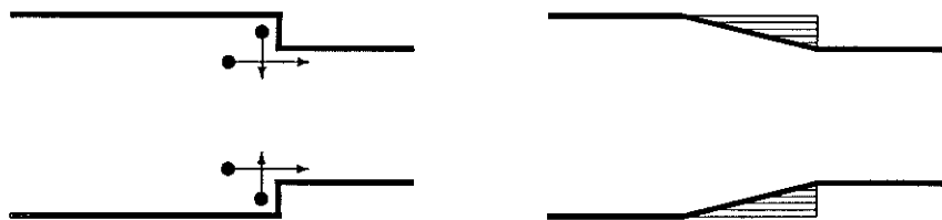
Abbildung 6.1: Effizienzsteigerung durch Vermeidung von Ecken (aus [Hel97])
